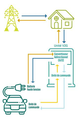
4 | Système dans lequel un flux d'énergie électrique circule entre les véhicules électriques à batterie (VEB) et le réseau électrique.
